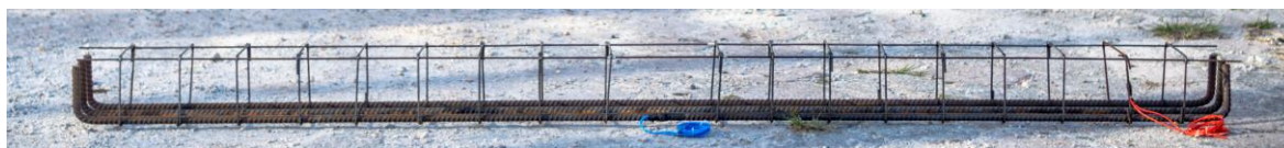
Figura 4.11 – Armadura da Viga VB2
