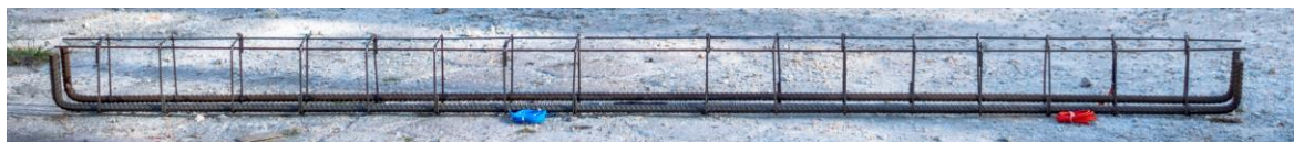
Figura 4.10 – Armadura da Viga VB1
