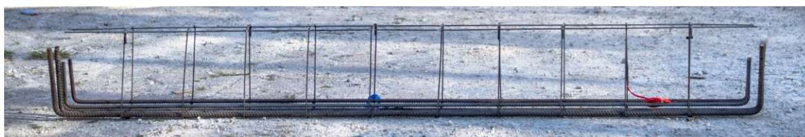
Figura 4.13 – Armadura da Viga VD2
