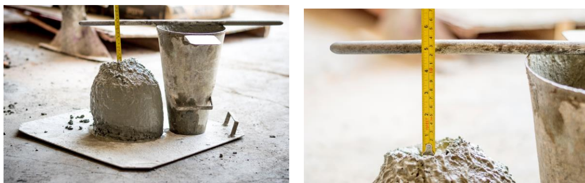
Figura 4.16 – Ensaio de consistência ( Slump Test )
