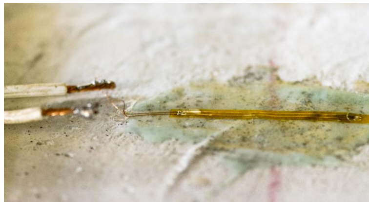
Figura 4.23 – Detalhe do extensômetro do concreto
